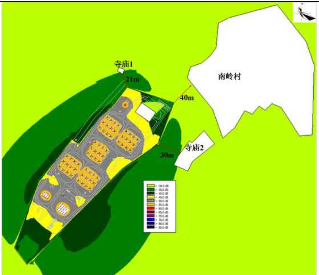
图 4.3-3 拟建储能站噪声等声值线图（离地 3.0m）
